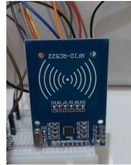
Gambar 10. Penerapan Sensor RFID
