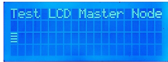
Gambar 6. LCD pada Node master menampilkan data dari Serial Input
