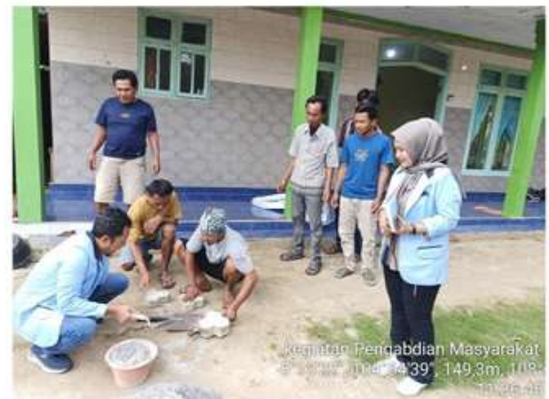
Gambar 2. Praktik pencampuran abu sekam padi dengan semen dan pasir pada pelatihan pembuatan paving block.
